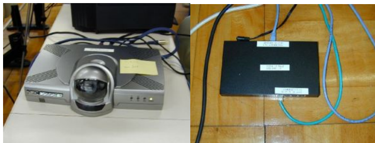
図-6 障害学会で使用された機器 (左：テレビ会議システム、右：VPN ルーター) [4]
